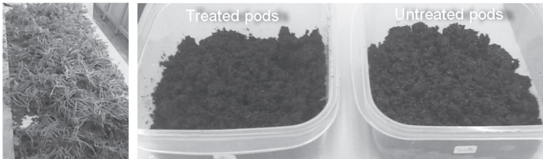
ภาพที่ 1 ฝักไมยราบยักษ์แห้ง (ซ้าย) ผ่านการบดและปรับสภาพด้วยสารละลาย NaOH 1.5 โมลาร์ (กลาง) และไม่ได้ผ่านการปรับสภาพ (ขวา)
