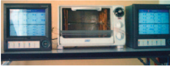
รูปที่ 7 การทดสอบเตาอบที่ติดตั้งท่อความร้อนแบบสั้นปลายปิด [7]
