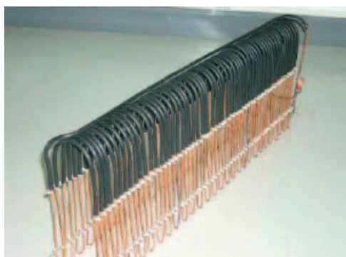
รูปที่ 12 ชุดท่อความร้อน CLOHP/CV [12]
