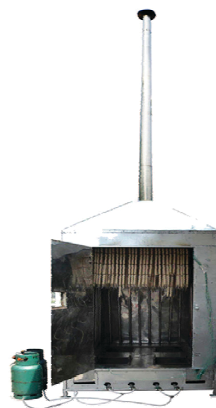
รูปที่ 6 เตาอบไส้กรอกปลาที่ติดตั้งเทอร์โมไซฟอน [6]
