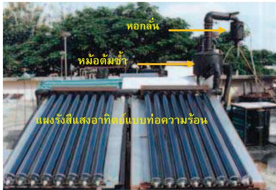
รูปที่ 21 แสดงภาพโดยรวมของชุดทดสอบการกลั่นเอทานอลแบบสแตนด์เอโลนที่มีการใช้หอกลิ้น [16]
