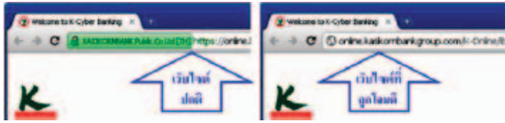
รูปที่ 2 เปรียบเทียบเว็บไซต์ปกติที่แสดง HTTPS และใช้ EV-SSL เพื่อแสดงข้อมูลใบรับรองกับผลของเว็บไซต์เมื่อถูกโจมตีด้วย SSL Strip
