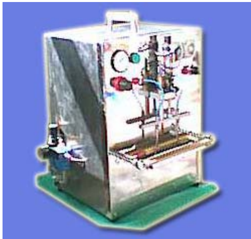
รูปที่ 8 เครื่องปิดผนึกของพร้อมบรรจุภัณฑ์ไนโตรเจน
