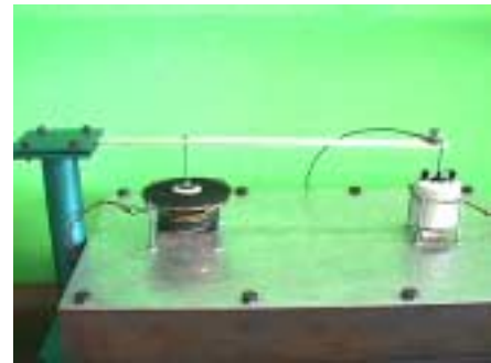
รูปที่ 7 อุปกรณ์กระตุ้นที่ติดกับคานยื่นเพื่อทดสอบตัวควบคุม
