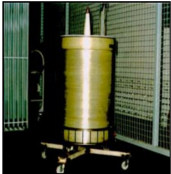
ภาพที่ 12 หม้อแปลงทดสอบที่สร้างเสร็จแล้ว
