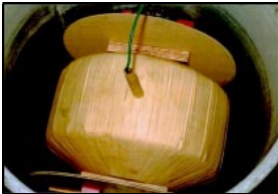
ภาพที่ 10 การทดลองประกอบลงถัง
