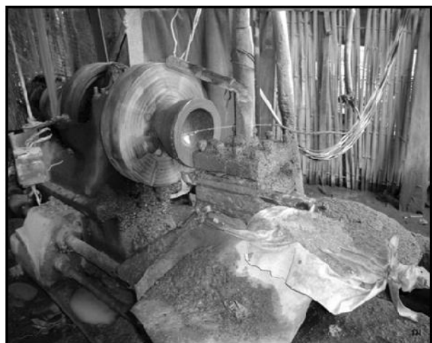
รูปที่ 1 แสดงการทำงานของเครื่องจักรในการกลึงขึ้นรูปครกหิน
