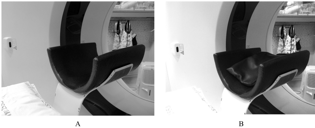
รูปที่ 1 ฐานรองศีรษะผู้รับบริการของเครื่องเอกซเรย์คอมพิวเตอร์ (A) ฐานรองศีรษะปกติ (ไม่ใช้หมอน) (B) ฐานรองศีรษะที่เสริมด้วยหมอนรองศีรษะที่จัดสร้างขึ้นมา
