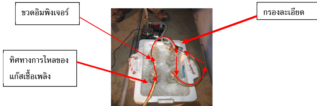
รูปที่ 3 อุปกรณ์เก็บตัวอย่างแก๊สเชื้อเพลิงดูเก็บตัวอย่างแก๊สเชื้อเพลิง เป็นถุงอลูมิเนียมทึบแสงขนาด 2 ลิตร สำหรับเก็บ ตัวอย่างแก๊สเชื้อเพลิงที่ไหลจากระบบบำบัดแก๊สเชื้อเพลิงขั้นสุดท้าย ลักษณะดูเก็บแก๊สเชื้อเพลิง แสดงดังรูปที่ 4
