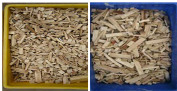
รูปที่ 2 เศษไม้จากโรงงานเฟอร์นิเจอร์ที่ใช้เป็นเชื้อเพลิง
