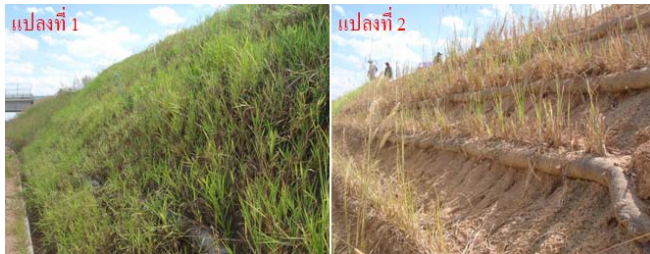
รูปที่ 19 การเปรียบเทียบการกัดเซาะที่เกิดขึ้นจริงในสนามของทั้ง 2 แปลงทดสอบ วันที่ 7 มีนาคม 2553 ภายหลังจากการติดตั้งผ้าห่มดินและหมอนกันดินร่วมกับการปลูกพืช
