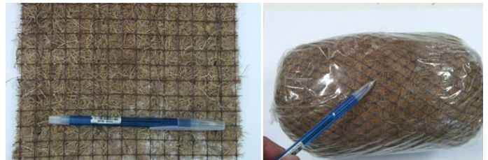
รูปที่ 1 ฟ้ามัดดิน (ซ้าย) และ หมอนกันดิน (ขวา)
