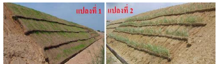
รูปที่ 2 แปลงทดสอบที่ 1 (ฟ้ามัดดิน) และแปลงทดสอบที่ 2 (หญ้าแฝก) ภายหลังติดตั้งเสร็จ 1 วัน (9 เมษายน 2552)
