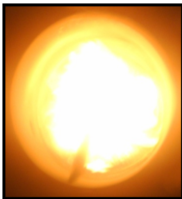
รูปที่ 3 ลักษณะเปลวไฟของการเผาไหม้ในหัวพ่นไฟวัสดุพอร์นชนิดตาข่ายสแตนเลสขนาดความถี่ 16 เมช
