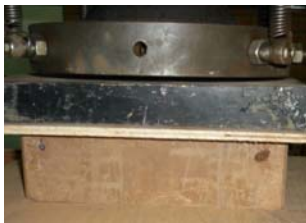
รูปที่ 4 ตัวอย่างการทดสอบค่าลึงอัดบล็อกประสาน
