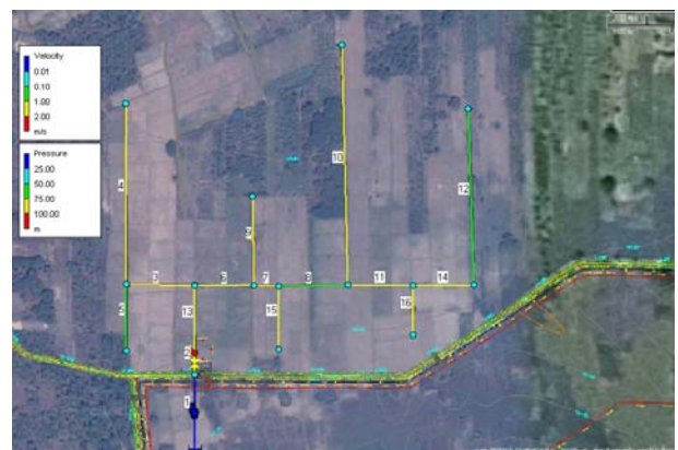
รูปที่ 6 ความเร็วการไหลและแรงดันในเส้นท่อ
