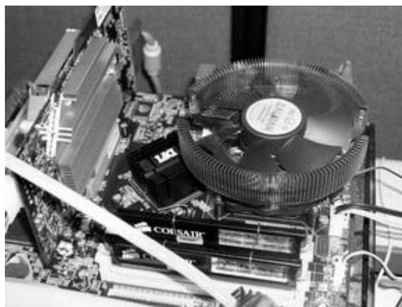
รูปที่ 10 การเพิ่มพัดลมที่มีขนาดใหญ่ขึ้น ทำให้เกิดเสียงดังและสั่น
