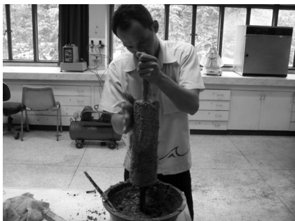
รูปที่ 2 การพอกส่วนผสมขึ้นรูปลูกหินขัดข้าว
