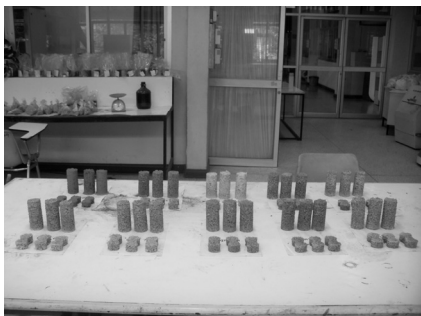
รูปที่ 1 ชิ้นงานทดสอบความต้านทานแรงอัดและความต้านทานแรงดึง
