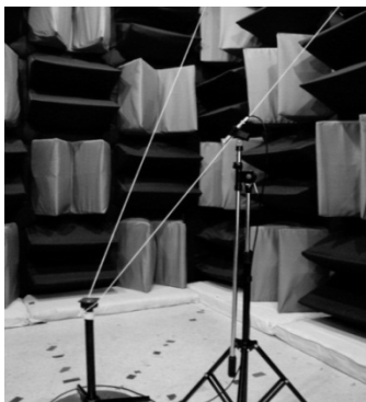
รูปที่ 10 (ก) ระยะและทิศทางการวัดระดับความดันเสียง (ข) การทดสอบความเป็นฟรีฟิลด์
