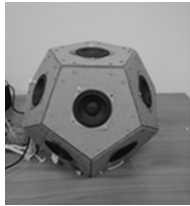
รูปที่ 9 ลำโพงขนาดเล็กจำนวนหลายดอก ประกอบกันเป็น Omni source
