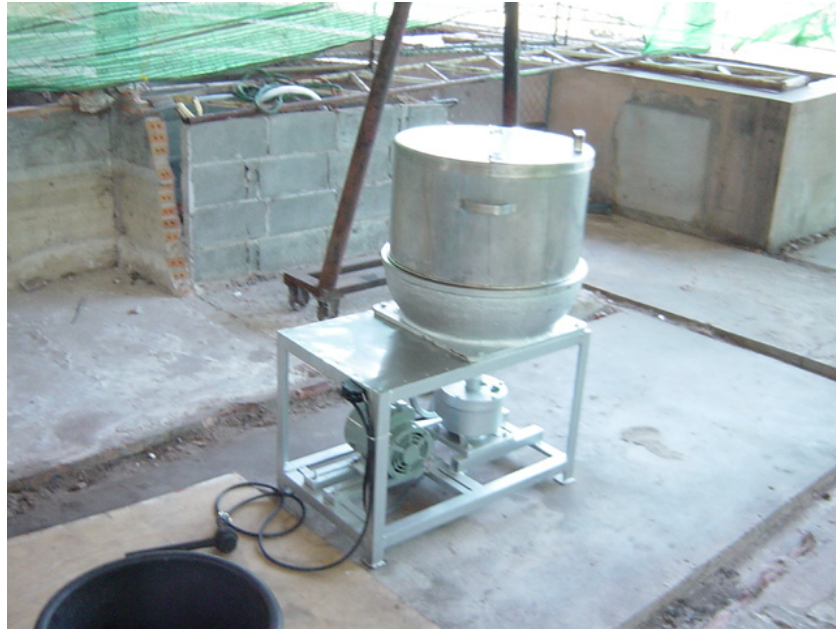
รูปที่ 3 เครื่องบดงาที่สร้างเสร็จ
