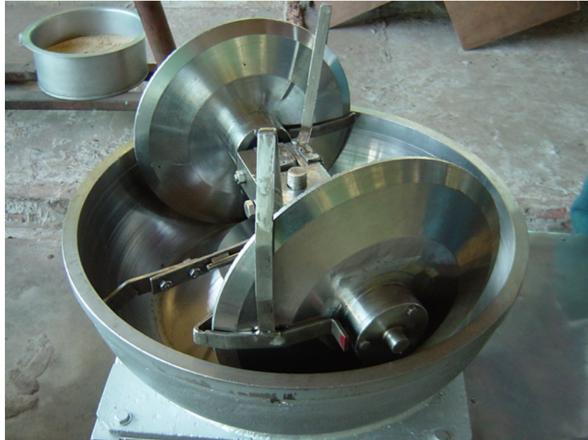
รูปที่ 4 อ่างใส่ผลิตภัณฑ์ ล้อบด และใบปาดที่ขอบล้อบดที่ประกอบเสร็จแล้ว
