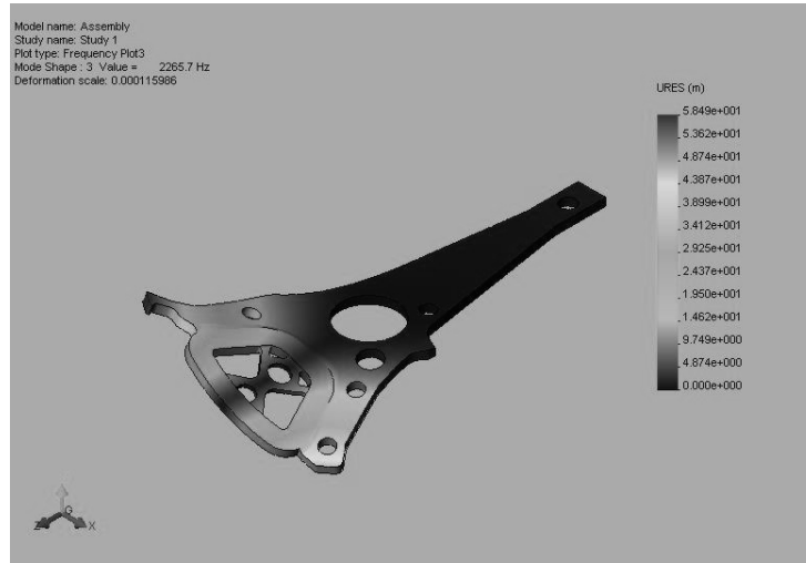
รูปที่ 9 แสดงรูปแบบการเคลื่อนที่จากการบิดของคอยล์ (Coil Torsion) ในโหมดที่ 3
