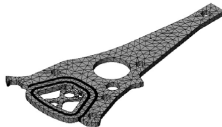
รูปที่ 3 การแบ่งรูปร่างของปัญหาหรือแบบจำลองของออกเป็นเอลิเมนต์ย่อยๆ
