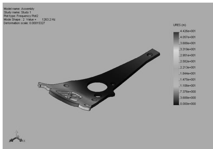
รูปที่ 8 แสดงรูปแบบการเคลื่อนที่ในส่วนของคอยล์ (Coil Bending) ในโหมดที่ 2
