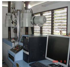
รูปที่ 3 แสดงเครื่องทดสอบ Compressive Testing Machine ที่ใช้ในการศึกษา
