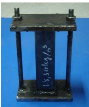
รูปที่ 2 แสดงอุปกรณ์ควบคุมความหนาแน่นของโฟมขณะใช้งาน
