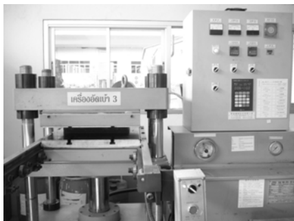
รูปที่ 2 การอัดขึ้นรูปชิ้นงานด้วยเครื่องอัดขึ้นรูป
