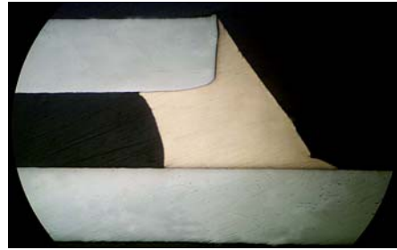
รูปที่ 2 การเตรียมชิ้นงานก่อนการตรวจสอบ รูปที่ 3 ลักษณะการวัดระยะการแทรกตัวของลวดเติม
