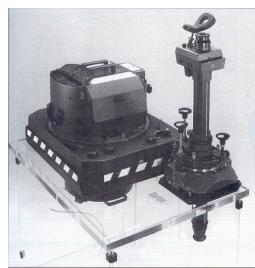
รูปที่ 4 กล้องถ่ายภาพทางอากาศรุ่น Leica RC30
