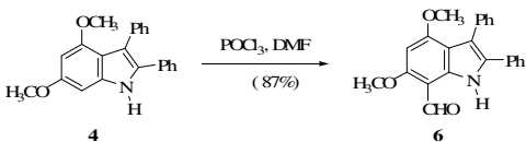
รูปที่ 5 การสังเคราะห์สาร 7-formyl-4,6-dimethoxy-2,3-diphenylindole ( 6 )
