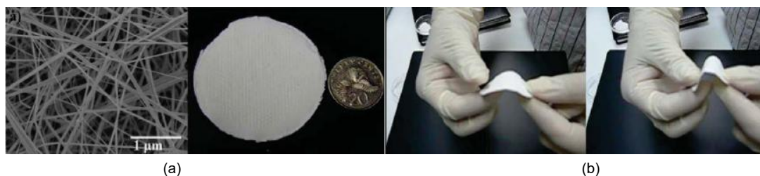
รูปที่ 13 แสดงลักษณะวิทยาของ (a) เยื่อเลือกผ่านเส้นใยนาโนไทเทเนียมไดออกไซด์ และ (b) เยื่อเลือกผ่านที่สามารถโค้งงอได้ [19]
