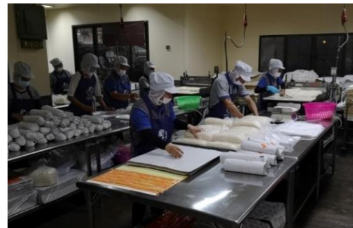
รูปที่ 8 การบรรจุเส้นก๋วยเตี๋ยวแบบเส้นกึ่งแห้ง
