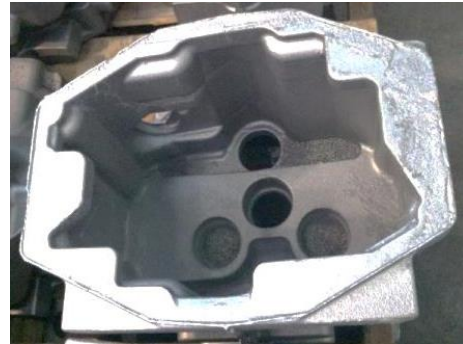
รูปที่ 3 ของเสียประเภทข้อบกพร่องผิวไม่เรียบด้านในชิ้นงาน
