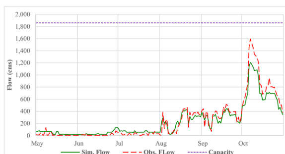
รูปที่ 6 กราฟเปรียบเทียบค่าจำลองกับค่าสำรวจ ที่สถานี P.12C
