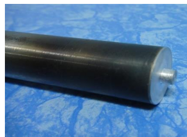
รูปที่ 1 หัวพินทรงกระบอกที่ใช้ในการเชื่อม
