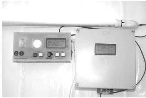
รูปที่ 2 อุปกรณ์ควบคุมความสว่างหลอดแอลอีดี
