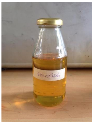
รูปที่ 5 ไบโอดีเซลบริสุทธิ์จากการผ่านกระบวนการล้างน้ำและระเหยน้ำออก
