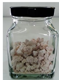
รูปที่ 6 สารดูดซับแอมโมเนียมแมกนีเซียมซิลิเกตที่สังเคราะห์
