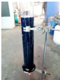
รูปที่ 7 การแช่ไบโอดีเซลในซิลิกาเจล
