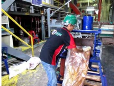
ภาพที่ 21 แสดงการป้อนถุงเข้าสู่เครื่องรีด
