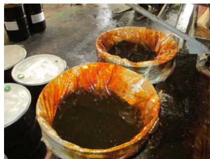
รูปที่ 5 แสดงการพับปากถุงเพื่อเทวัตถุดิบ
