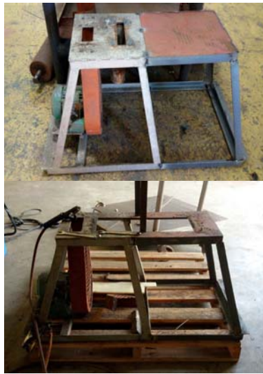
รูปที่ 11 แสดงฐานเครื่องรีดถุงบรรจุวัตถุดิบน้ำมัน LICO
