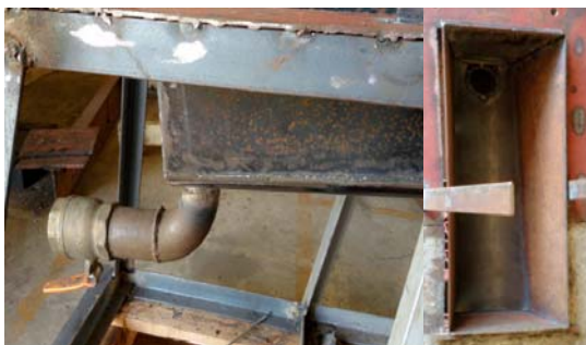
รูปที่ 12 แสดงภาชนะรองรับน้ำมัน LICO
