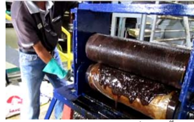
รูปที่ 23 แสดงการหมุนโรลเลอร์เพื่อรีดน้ำมันจนหมด
