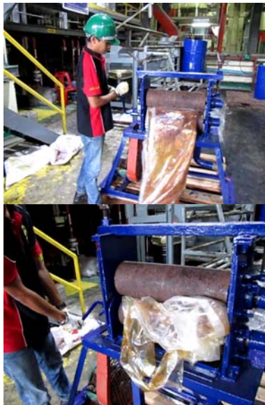
รูปที่ 22 แสดงการหมุนโรลเลอร์เพื่อรีดน้ำมัน
