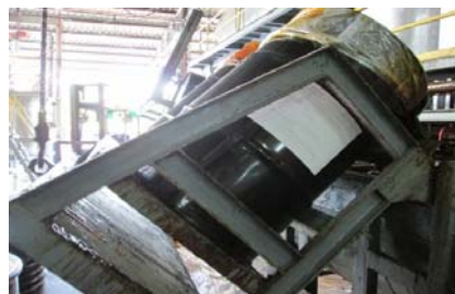
รูปที่ 6 แสดงการเทวัตถุดิบโดยการใช้อรอก
