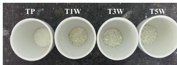
รูปที่ 5 ลักษณะผงไทเทเนียมไดออกไซด์เจือด้วยทั้งสเดนออกไซด์หลังเผาที่อุณหภูมิ 500 องศาเซลเซียส เป็นเวลา 2 ชั่วโมง
