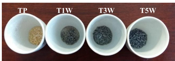
รูปที่ 4 ลักษณะผงไทเทเนียมไดออกไซด์เจือด้วยทั้งสเดนออกไซด์ หลังอบให้แห้งที่อุณหภูมิ 100 องศาเซลเซียส เป็นเวลา 24 ชั่วโมง
