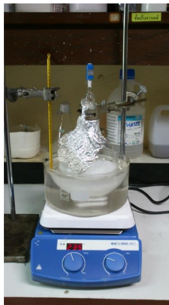
รูปที่ 6 ติดตั้งถึงปฏิกรณ์ในระดับห้องปฏิบัติการ
