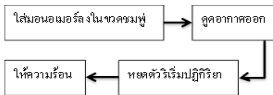
รูปที่ 4 ขั้นตอนการสังเคราะห์พอลิเมอร์ในห้องปฏิบัติการ
