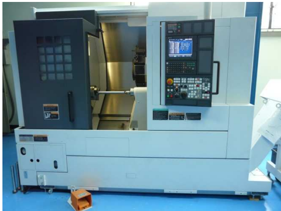
รูปที่ 1 เครื่องกลึงซีเอ็นซี (CNC Lathe) รุ่น NL1500
