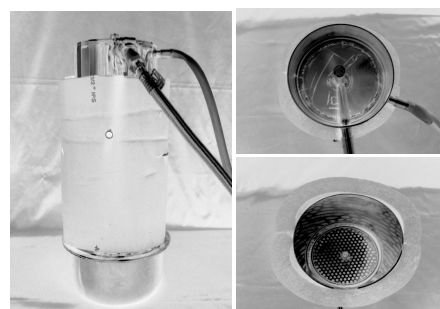
รูปที่ 2 ถังกลั่นต้นแบบขนาดเล็กในระบบแยกไอน้ำจากสารผสมเอทานอล-น้ำ
