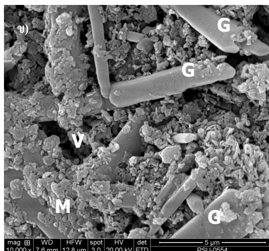
รูปที่ 12 ภาพถ่ายจุลทรรศน์อิเล็กตรอนแบบส่องกราดของ ดินที่ปรับปรุงสูตร CRGW2 ด้วยกำลังขยาย (ก) 5,000 เท่า และ (ข) 10,000 เท่า
