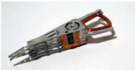
รูปที่ 1 แสดงส่วนประกอบต่าง ๆ ของแอ็คทูเอเตอร์ ซึ่งจะถูกนำไปประกอบเป็นส่วนหนึ่งของฮาร์ดดิสก์ไดรฟ์
