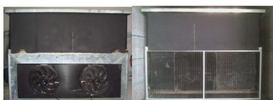
รูปที่ 3 ระบบระบายน้ำความร้อน ประกอบด้วยถังน้ำแข็ง ชุดท่อความร้อนแบบเทอร์โมไชฟอน และพัดลมหมุนเวียนอากาศ
