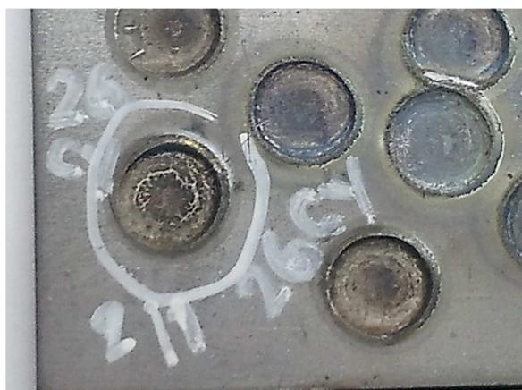
รูปที่ 9 ชิ้นงานทดสอบที่ผ่านการเชื่อมจนกระแท้หัวเชื่อม เริ่มเปลี่ยนรูปทรงที่เวลาในการเชื่อม 26 ไซเคิล
