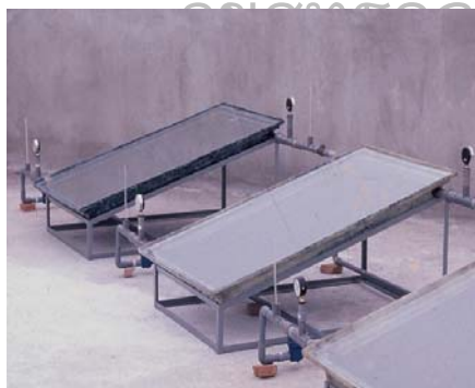
รูปที่ 14 ตัวเก็บรังสีอาทิตย์ ที่ตัวถังเป็น FRP[5]
