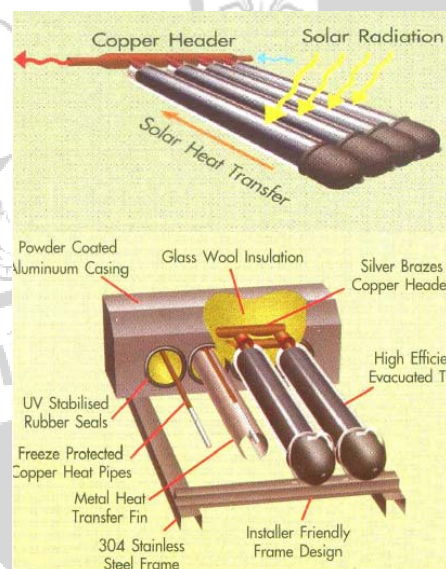
รูปที่ 15 ตัวเก็บรังสีอาทิตย์ ที่ใช้ท่อความร้อนบรรจุในท่อแก้วสุญญากาศ [8]
