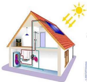
รูปที่ 11 ระบบทำน้ำร้อนแสงอาทิตย์แบบแอคทีฟ
