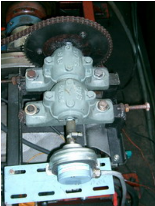
รูปที่ 9 Crank Angle Encoder และการติดตั้ง
