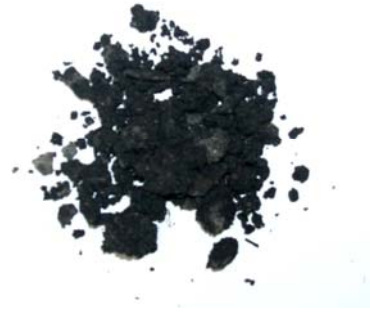
รูปที่ 13 ขยะอิเล็กทรอนิกส์ตัวอย่างที่มีการแปรสภาพ หลังการเผาทำลาย 2 นาที
