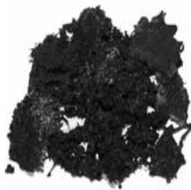
รูปที่ 12 ขยะอิเล็กทรอนิกส์ตัวอย่างที่มีการแปรสภาพ หลังการเผาทำลาย 1 นาที
