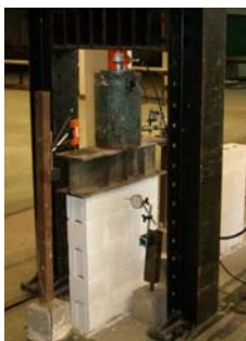
รูปที่ 3 การติดตั้งอุปกรณ์การทดสอบปรีซึม
